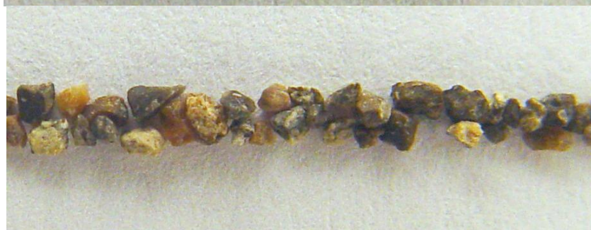
Рисунок 5 - Образец, фракция (2-1мм). Монофракции кварца и полевого шпата по типоморфным признакам
